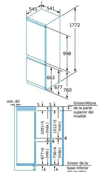
Las dimensiones dadas de la puerta del mueble corresponden a una junta de puerta de 4 mm.
