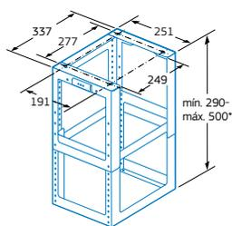
\* Altura regulable en intervalos de 20 mm
