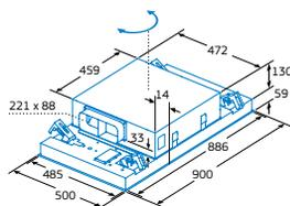
La salida del ventilador puede girarse en las cuatro direcciones
