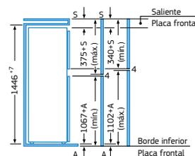
Las dimensiones dadas de la puerta del mueble corresponden a una junta de puerta de 4 mm. Si se utiliza un ancho de la junta diferente (máx. 14 mm) deben adaptarse las medidas.
