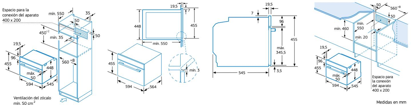
\*No se recomienda la instalación en horizontal de este modelo junto a otros hornos compactos de Balay.
