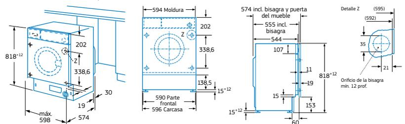
Posibilidad de intercambiar la fijación de la puerta del mueble a izquierda o derecha.
