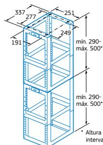
\* Altura regulable en intervalos de 20 mm
