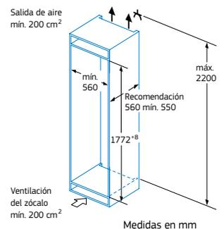
En caso de proceder a la instalación de dos combinados integrables juntos, es necesario dejar una distancia de separación de, al menos, 15 cm entre ellos.
