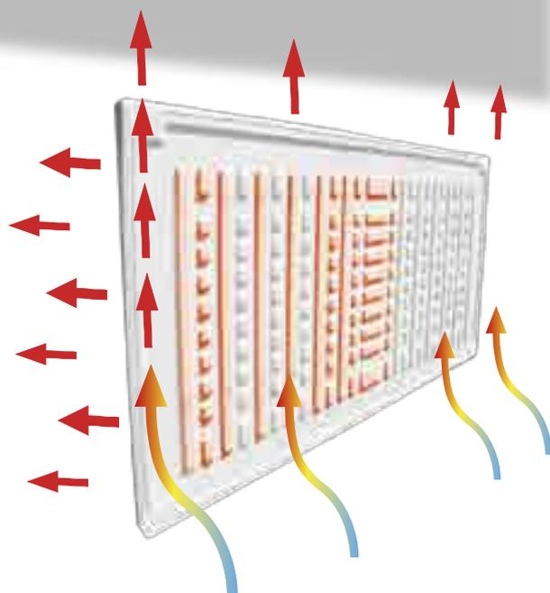
La parte frontal del panel incrementa la transferencia de calor durante un mayor tiempo debido a su capacidad de almacenamiento de calor (inercia).
