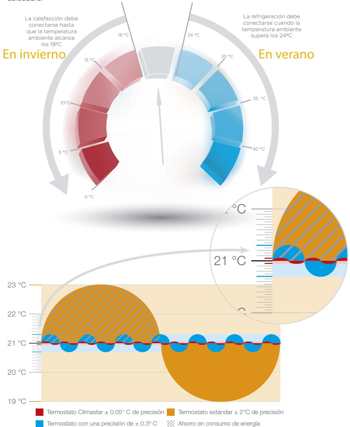
Los radiadores de inercia CLIMASTAR ofrecen el control de temperatura más exacto del mercado, ofreciendo así una mayor estabilidad térmica y evitando fluctuaciones de calor. El rango tiene una precisión de  $\pm 0,05^{\circ}\text{C}$  en comparación con otros fabricantes que ofrecen  $\pm 0,3^{\circ}\text{C}$  o incluso con los termostatos tradicionales con  $\pm 2^{\circ}\text{C}$ .
