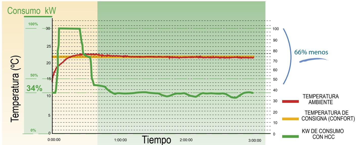
HCC activará la potencia máxima hasta alcanzar la temperatura confort lo antes posible.
