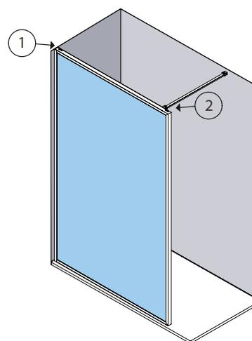
1 Ancho de perfil a pared      Compensación de perfil
