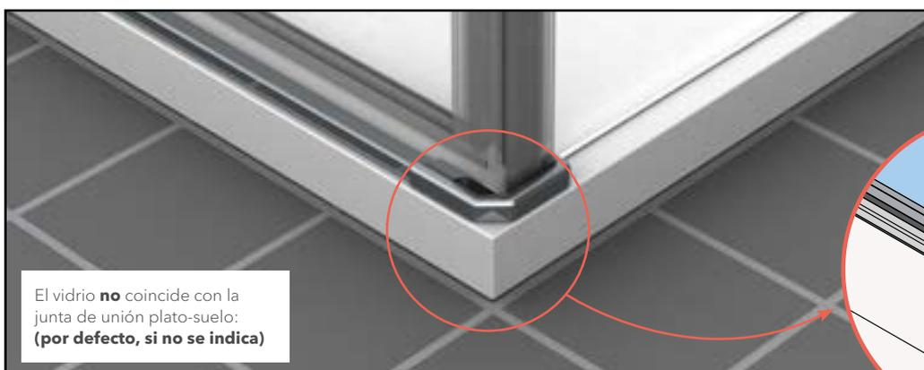
El vidrio **no** coincide con la junta de unión plato-suelo:
