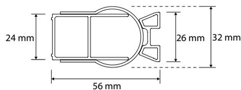
El conjunto de perfiles tiene una medida de 56 mm. El ancho del perfil a pared es de 24 mm, mientras que el perfil que marca los grados tiene un ancho de 26 mm. El diámetro del perfil circular es de 32 mm.
