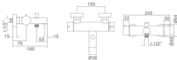
\*Dispositivo de seguridad que evita que el agua supere, de manera involuntaria, los 38°C de temperatura, previniendo quemaduras y mejorando el confort.
