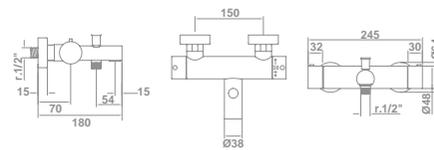
\*Dispositivo de seguridad que evita que el agua supere, de manera involuntaria, los 38°C de temperatura, previniendo quemaduras y mejorando el confort.
