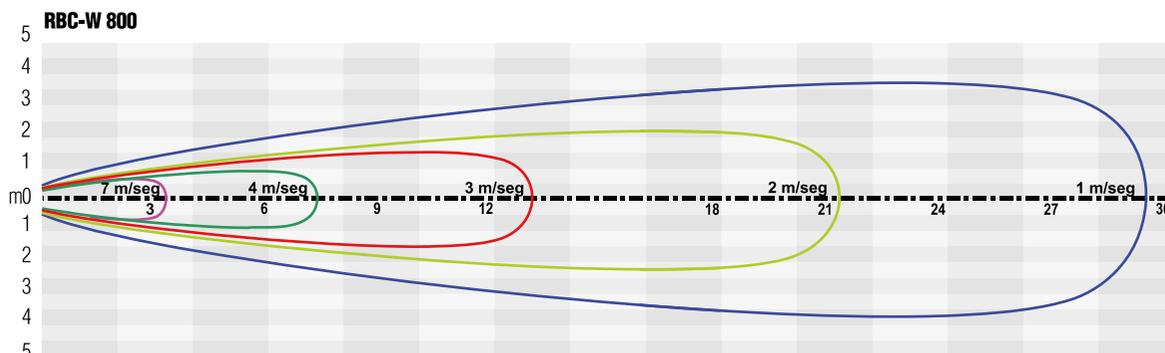
\*Datos obtenidos a condiciones estándar a máxima velocidad de operación. Velocidad: m/seg. Distancia: m
