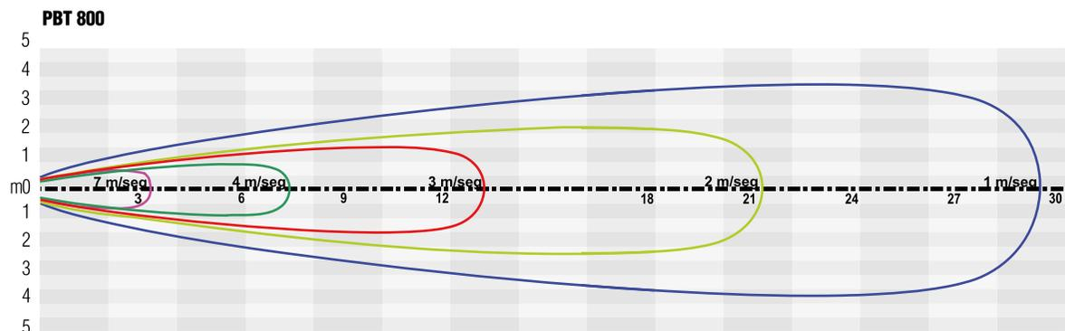
\*Datos obtenidos a condiciones estándar a máxima velocidad de operación. Velocidad: m/seg. Distancia: m
