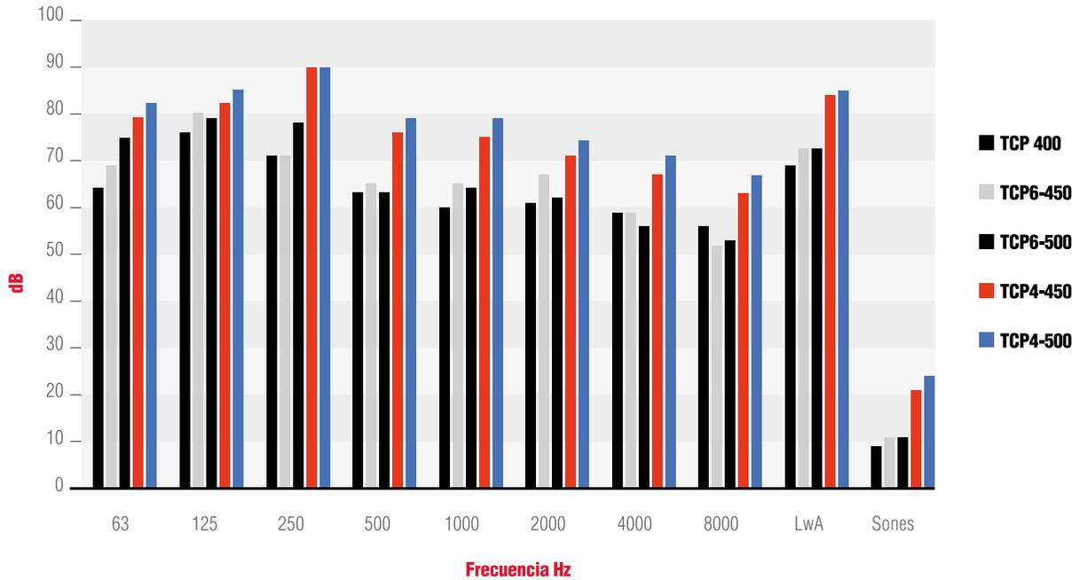
Los valores de potencia sonora (LwA) mostrados fueron realizados en instalación tipo A: Sin ducto en la succión, sin ducto en la descarga.
