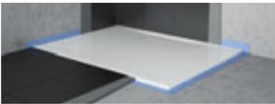
El kit de instalación de LAUFEN, compuesto por material de espuma dura, permite montar una amplia gama de platos de ducha a ras de suelo, además de aportar aislamiento acústico y térmico. Una cinta de protección periférica contribuye a evitar permanentemente y de forma segura que el agua penetre entre las baldosas y el plato de ducha.
