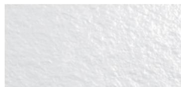
**Sanylite gel coat** es un material compuesto por un núcleo de GRP y una superficie de gel coat. Los productos fabricados con **sanylite gel coat** tienen un peso cuatro veces menor que el de productos equivalentes en **sanydur gel coat** u otros composites.
