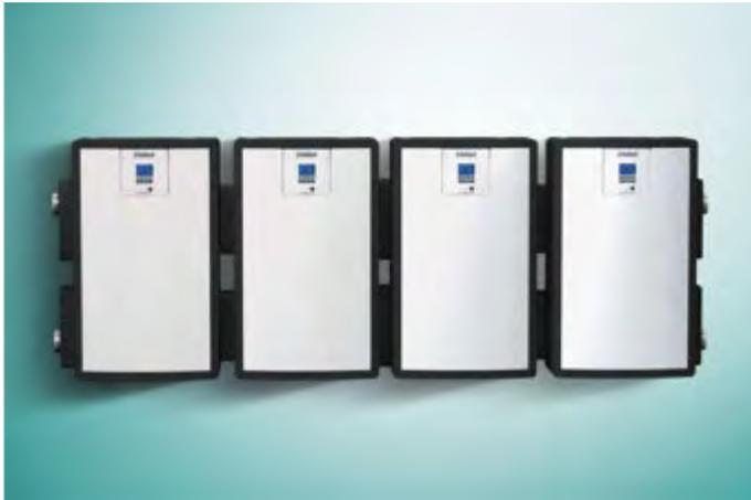
Pueden combinarse en cascada hasta cuatro unidades aguaFLOW exclusive. El resultado es que se puede abastecer de agua caliente hasta 105 viviendas estándar. Las estaciones de ACS pueden conectarse al depósito de inercia a la izquierda o a la derecha. Hay disponibles como accesorio consolas para el montaje en pared de 1, 2, 3 ó 4 módulos VPM /2 W.
