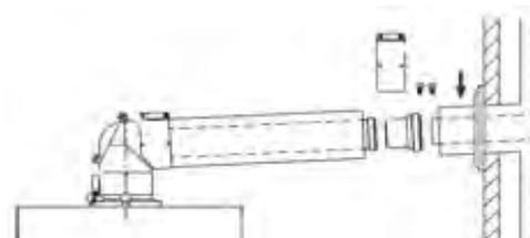
Longitud máxima entre caldera y chimenea: 10 m + 1 codo 87°
