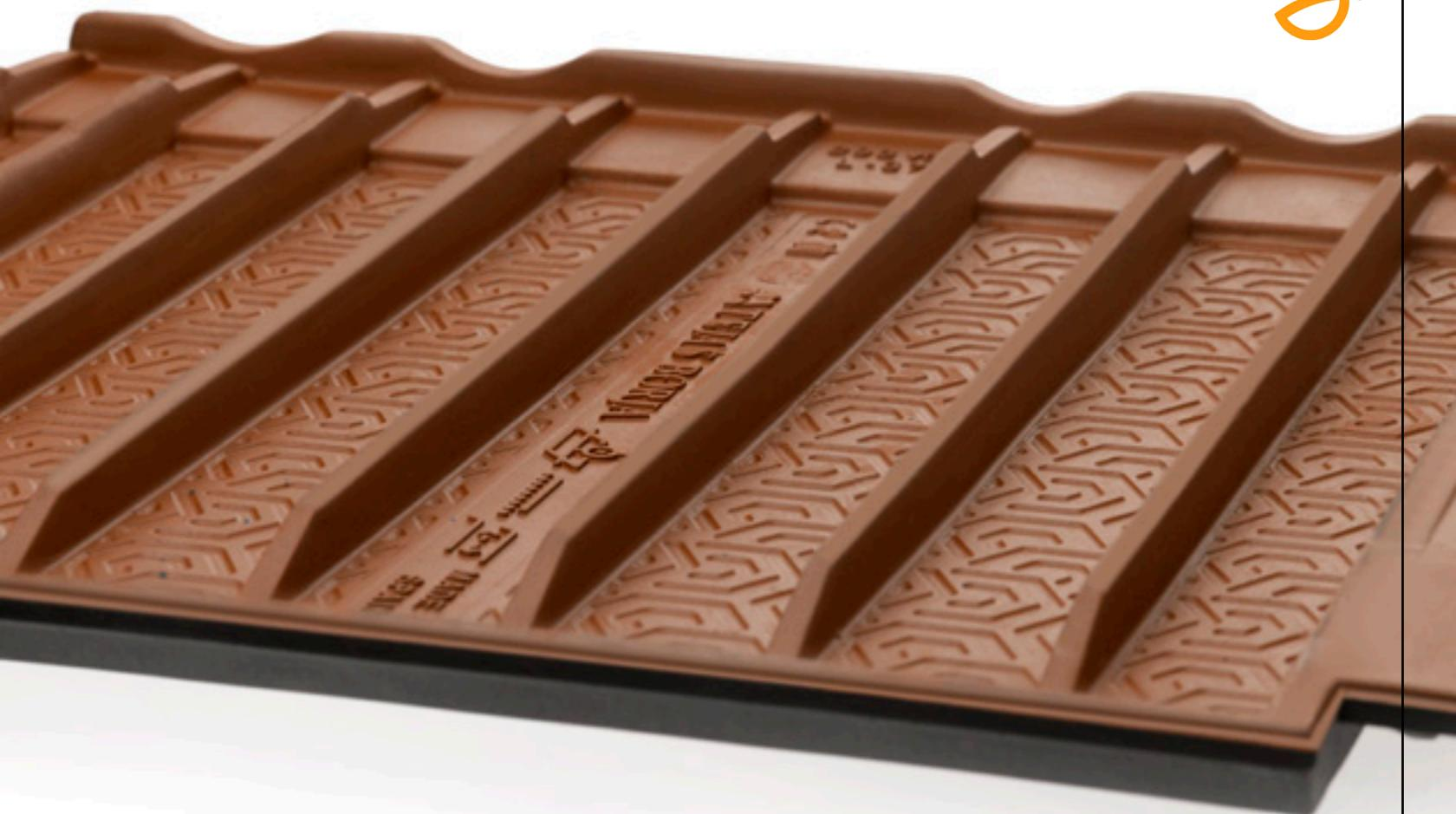
La incorporación del horno de rodillos junto con el uso de arcilla de gres proporcionan a nuestras tejas una planeidad perfecta, además de la mayor resistencia a la flexión con una muy baja absorción por debajo del 3%.
