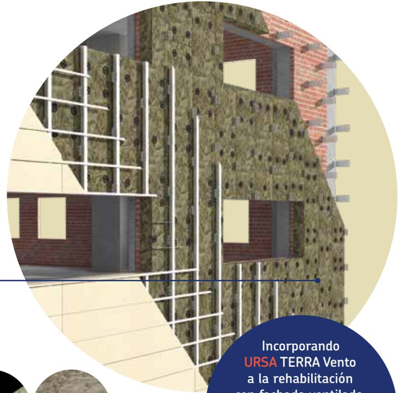
Incorporando **URSA TERRA Vento** a la rehabilitación con fachada ventilada, se consiguen ahorros de hasta el 50% del consumo energético y un incremento del aislamiento acústico
