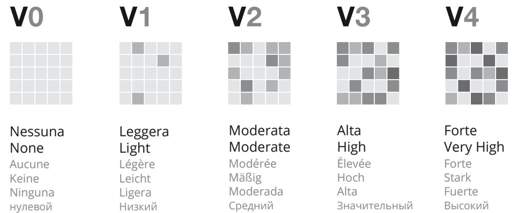
Le classement V-shade indique le niveau de mouvement chromatique au sein d'un produit. Il va de V0 à V4.
