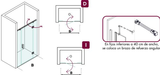
En fijos inferiores a 40 cm de ancho, se coloca un brazo de refuerzo angular
