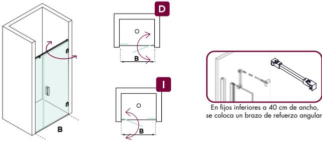
En fijos inferiores a 40 cm de ancho, se coloca un brazo de refuerzo angular
